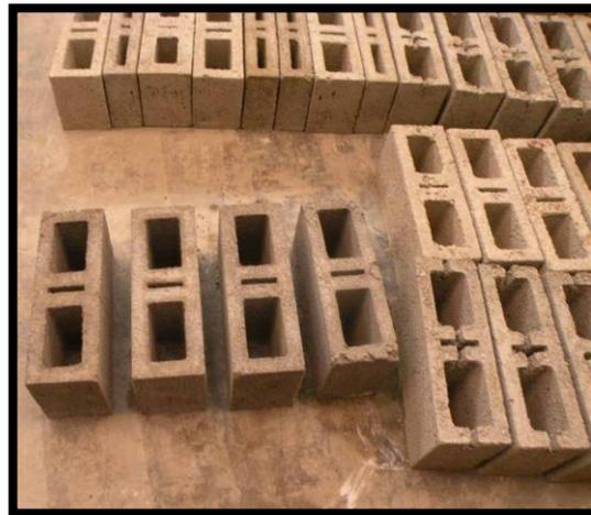
**Figura 6.** Ladrillos fabricados con cascarillas de arroz, que reemplaza parte del cemento empleado en la elaboración de concreto
