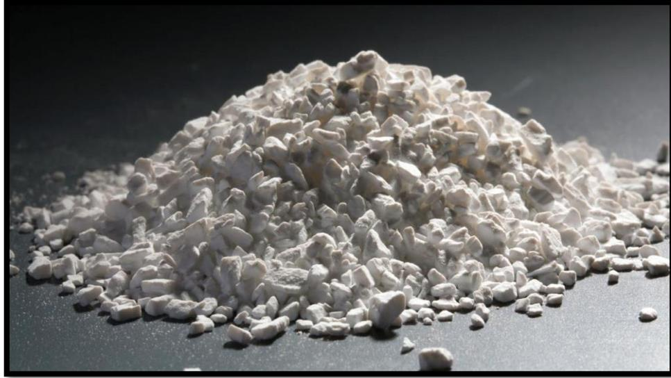
**Figura 12.** *Uso de sílice de ceniza de cáscara de arroz en neumáticos*
