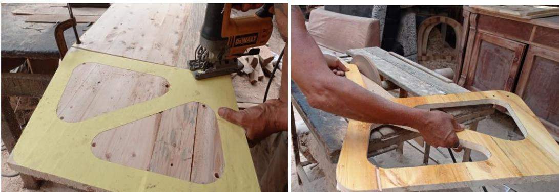
**Figura 24.** *Corte de módulos*
