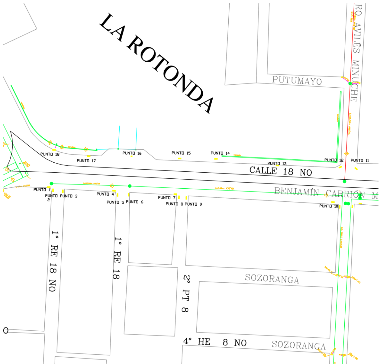
Figura 12 Ubicación de Sumideros en tramo Av. benjamín Carrión
