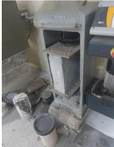
**Figura 37:** Bloques elaborados con mortero, botellas plásticas y malla metálica sometidos a ensayos de compresión (A)
