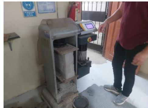
**Figura 39:** Bloques elaborados con mortero, botellas plásticas y malla metálica sometidos a ensayos de compresión (C)
