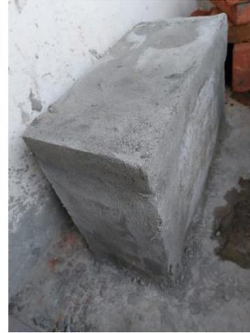
**Figura 24:** Bloque con mortero, botellas plásticas, malla metálica
