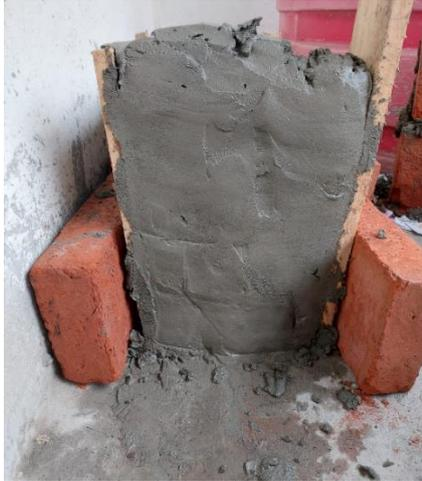
**Figura 34:** Elaboración de bloque con recubrimiento de mortero (C)
