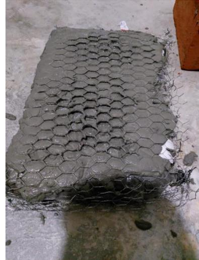
**Figura 32:** Elaboración de bloque con recubrimiento de mortero (A)
