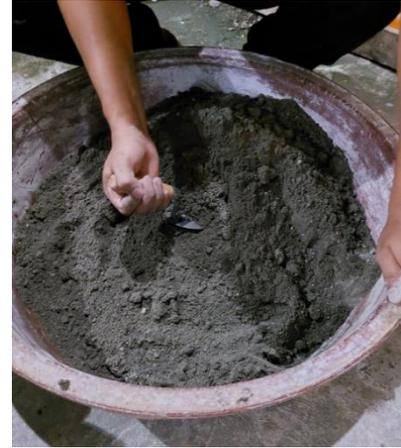
**Figura 28:** Material para mortero, cemento, arena, agua
