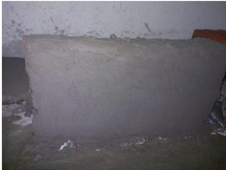
**Figura 23:** Elaboración del bloque con mortero, botellas plásticas, malla metálica (B)
