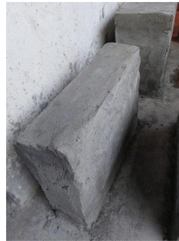
**Figura 36:** Bloques elaborados con morteros, botellas plásticas, malla metálica
