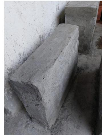
**Figura 25:** Elaboración de algunos bloques para ensayos a la compresión con mortero, botellas plásticas, malla metálica
