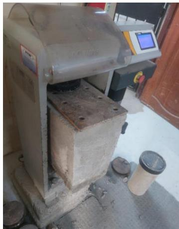
**Figura 38:** Bloques elaborados con mortero, botellas plásticas y malla metálica sometidos a ensayos de compresión (B)
