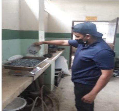
Foto 6: Peso del agregado grueso Elaborado por: Carpio y Villon (2023)
