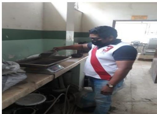
Foto 8: Peso de la ceniza de la hoja de plátano Elaborado por: Carpio y Villon (2023)
