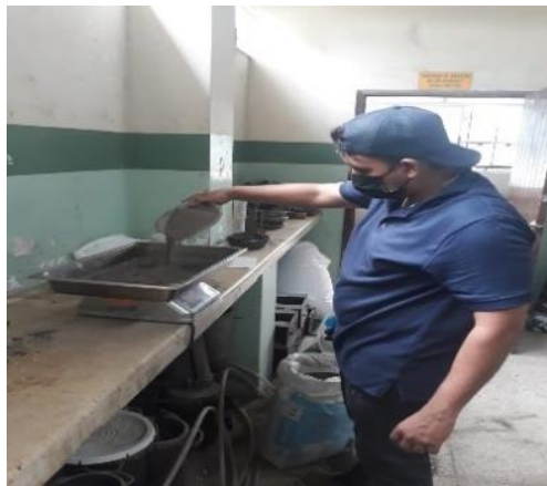
Foto 5: Peso del agregado fino Elaborado por: Carpio y Villon (2023)
