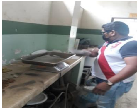
Foto 4: Peso del cemento Elaborado por: Carpio y Villon (2023)
