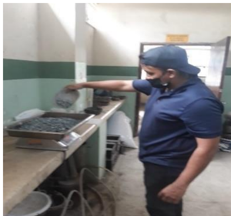
Foto 18: Peso del agregado grueso Elaborado por: Carpio y Villon (2023)
