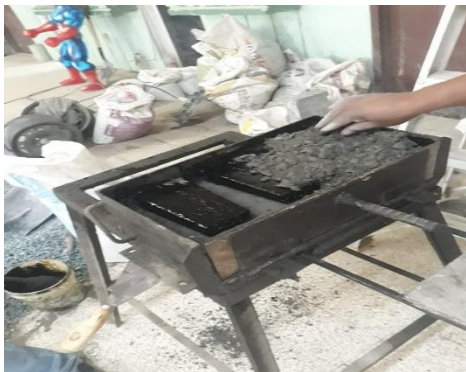
Foto 23: Elaboración de los bloques Elaborado por: Carpio y Villon (2023)
