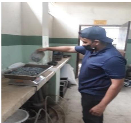
Foto 12 : Peso del agregado grueso Elaborado por: Carpio y Villon (2023)
