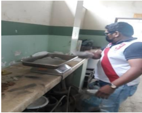
Foto 16: Peso del cemento Elaborado por: Carpio y Villon (2023)
