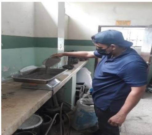
Foto 11: Peso del agregado fino Elaborado por: Carpio y Villon (2023)
