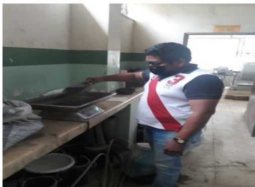
Foto 14: Peso de la ceniza de la hoja del plátano Elaborado por: Carpio y Villon (2023)
