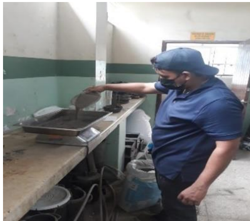
Foto 17: Peso del agregado fino Elaborado por: Carpio y Villon (2023)
