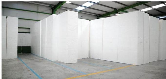
Figura 9. Bloques de Poliestireno Expandido.
