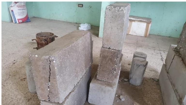
Figura 31. Ruptura del bloque tradicional.
