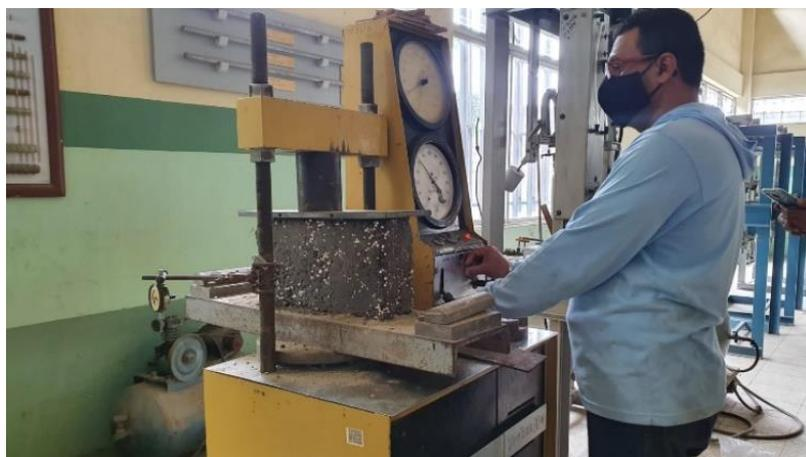
Figura 30. Ensayo de resistencia a la compresión simple de bloques alivianados.
