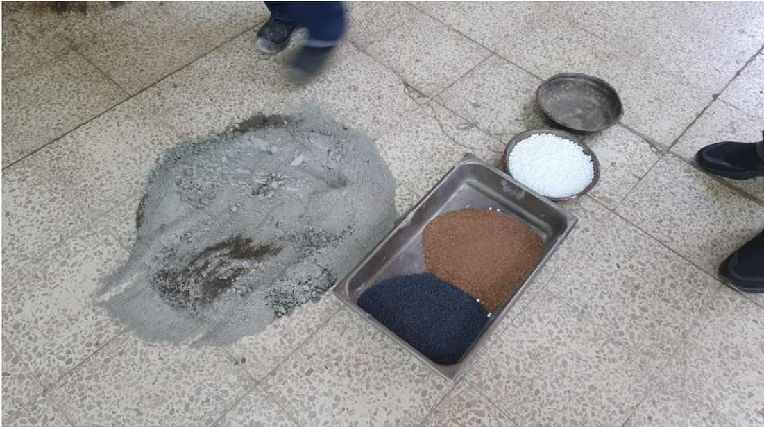
Arena, piedra chispa, cemento, agua, poliestireno, PET y vermiculita, listos para el mezclado.
