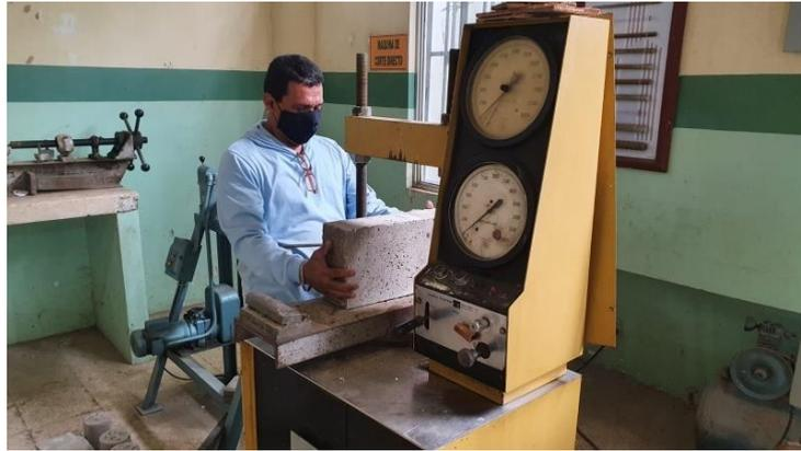
Figura 29. Ensayo de resistencia a la compresión simple de bloques tradicionales.
