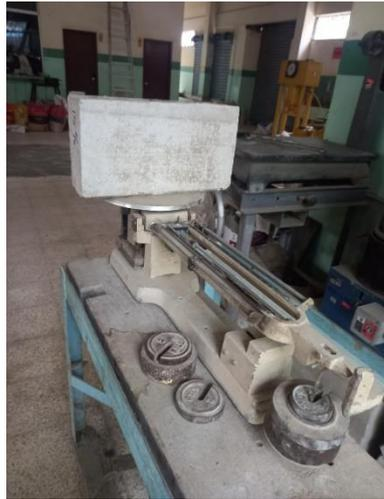
Figura 26. Pesado de bloque seco.
