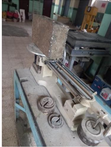
Figura 24. Determina masa de la muestra sumergida.
