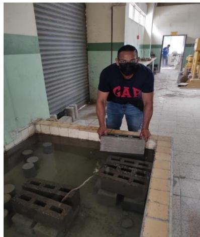
Figura 23. Bloque para prueba de absorción.
