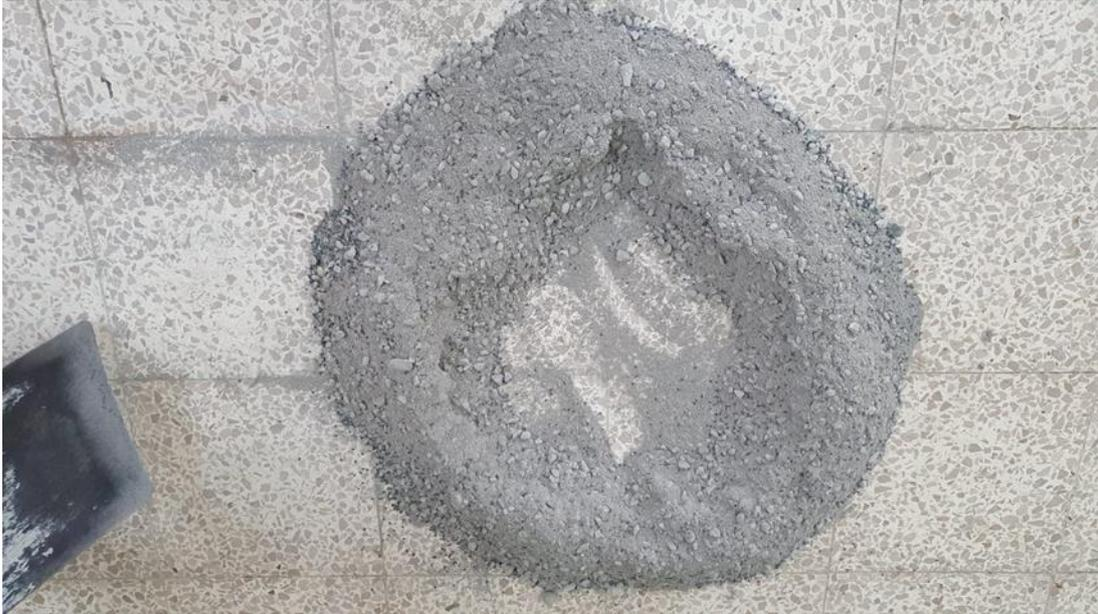
Mezclado en seco de arena, piedra chispa, cemento, PET y vermiculita.
