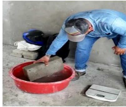
Figura 43: Proceso del peso por prueba de humedad. Elaborado por: Flores, G. y Tenesaca, J. (2022)
