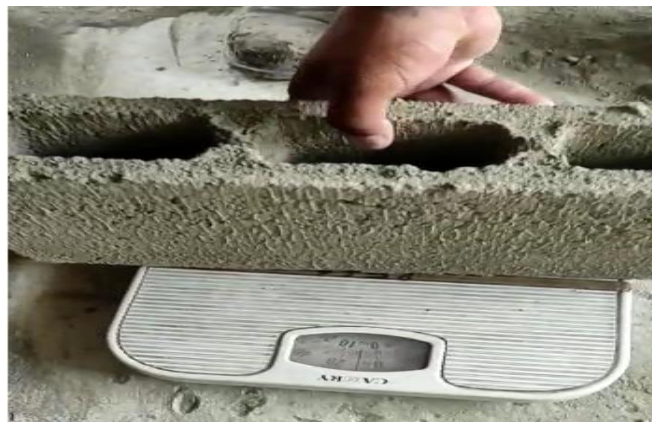
Figura 41: Toma de peso del bloque para prueba de humedad. Elaborado por: Flores, G. y Tenesaca, J. (2022)
