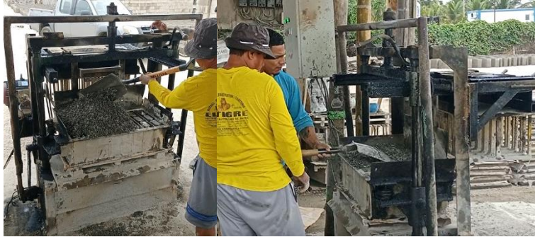
Figura 30: Colocación de la mezcla en la bloquera . Elaborado por: Flores, G. y Tenesaca, J. (2022)
