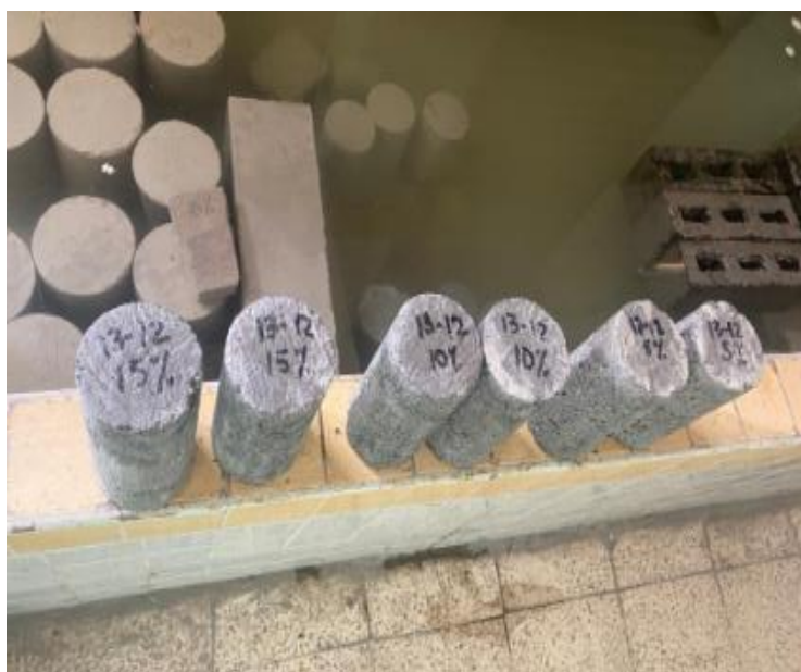
Figura 22: Cilindros de hormigón modificado al 5,10,15 % Elaborado por: Choez y Yáñez (2023)
