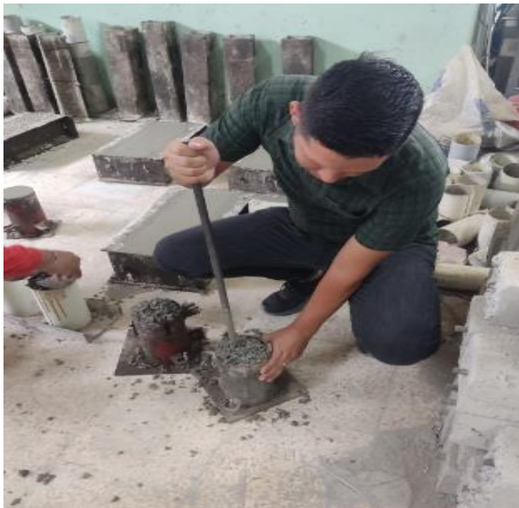
Figura 18: Preparación de cilindros con hormigón modificado Elaborado por: Choez y Yáñez (2023)
