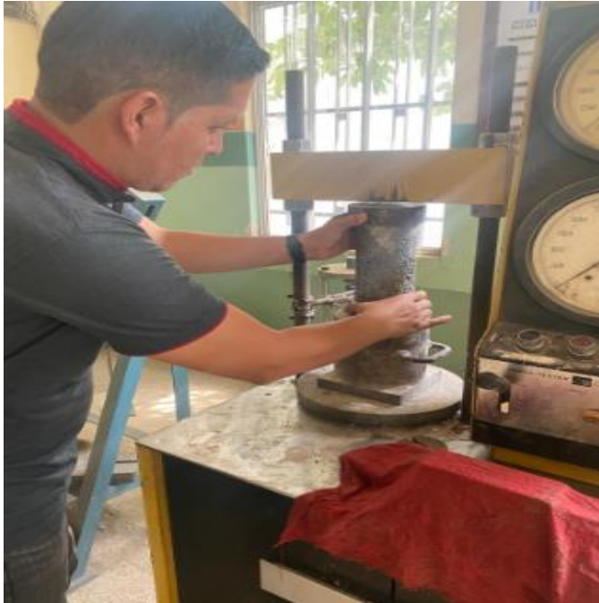
Figura 23: Ensayos de compresión de cilindros de hormigón modificado al 5,10,15 % Elaborado por: Choez y Yáñez (2023)
