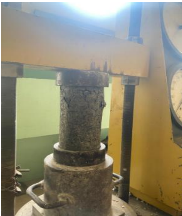
Figura 24: Ensayo de compresión Elaborado por: Choez y Yáñez (2023)
