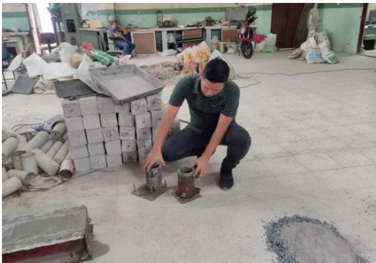
Figura 16: Preparación de cilindros Elaborado por: Choez y Yáñez (2023)
