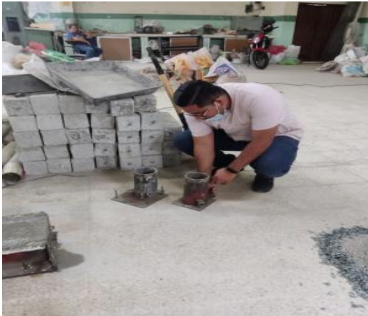
Figura 17: Preparación de cilindros con hormigón adicionando caucho granular Elaborado por: Choez y Yáñez (2023)
