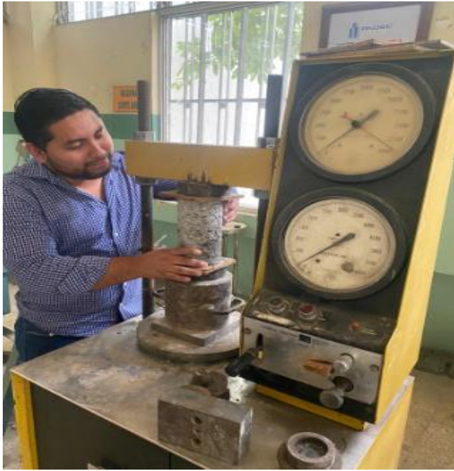
Figura 25: Ensayo de compresión Elaborado por: Choez y Yáñez (2023)
