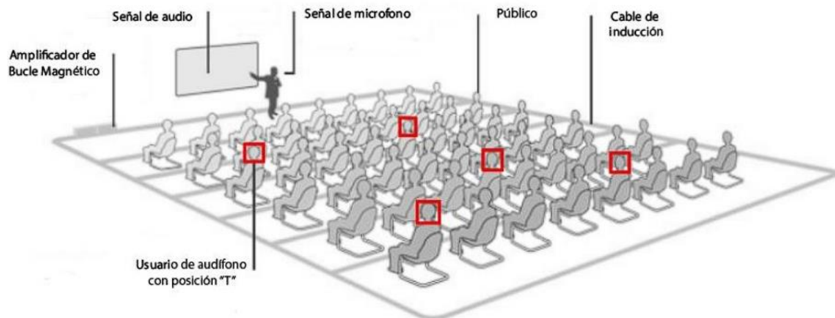
Ilustración 9 Instalación de bucles magnéticos en espacios de auditorio
