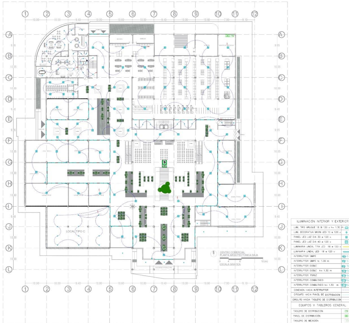
Figura 144. Plano Eléctrico (Planta Baja).
