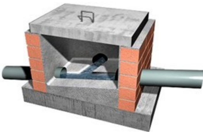
Figura 9. Caja de Registro Domiciliaria.
