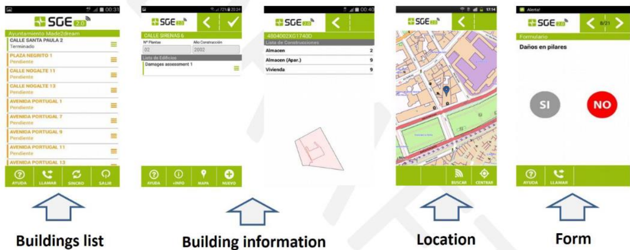
Figura 16 Prototipo aplicación Smartphone para la evaluación de daños SGE 2.0
