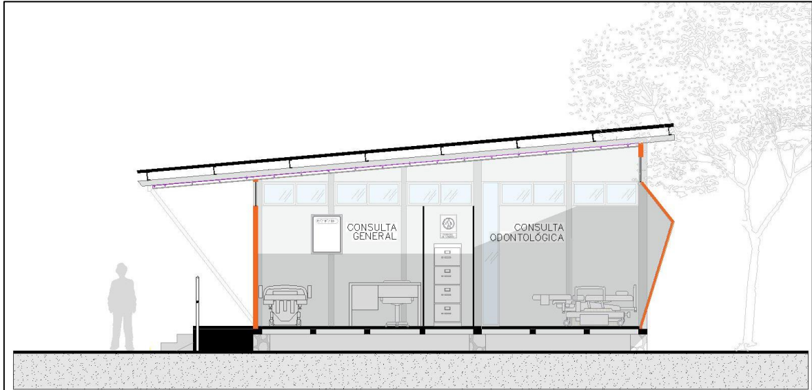
Figura 15. Vista en Corte C - C'. Paneles de Bambú marcados en color naranja.
