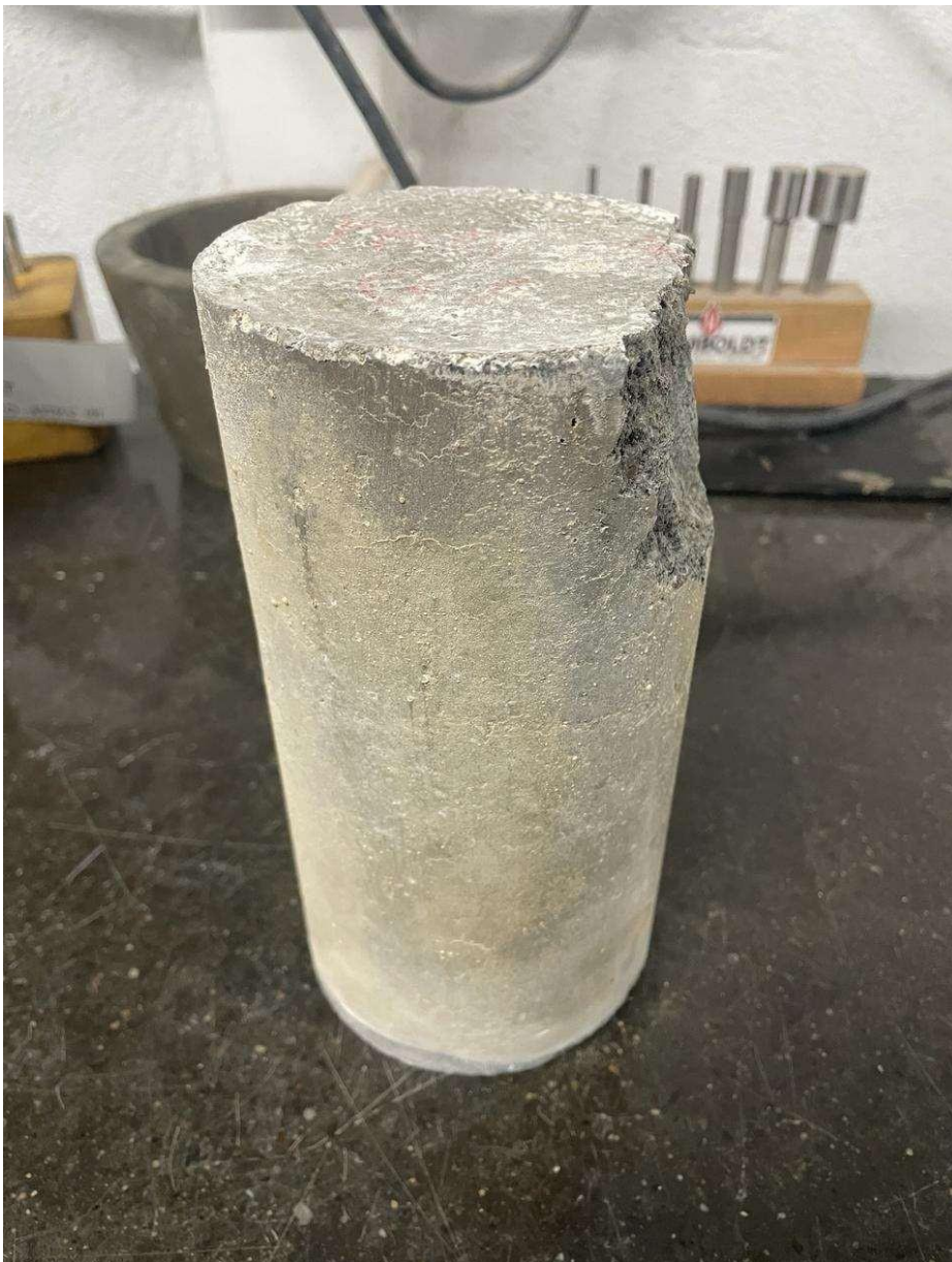
Anexo 37: Rotura tipo T5, hormigón tradicional edad (14 días).
