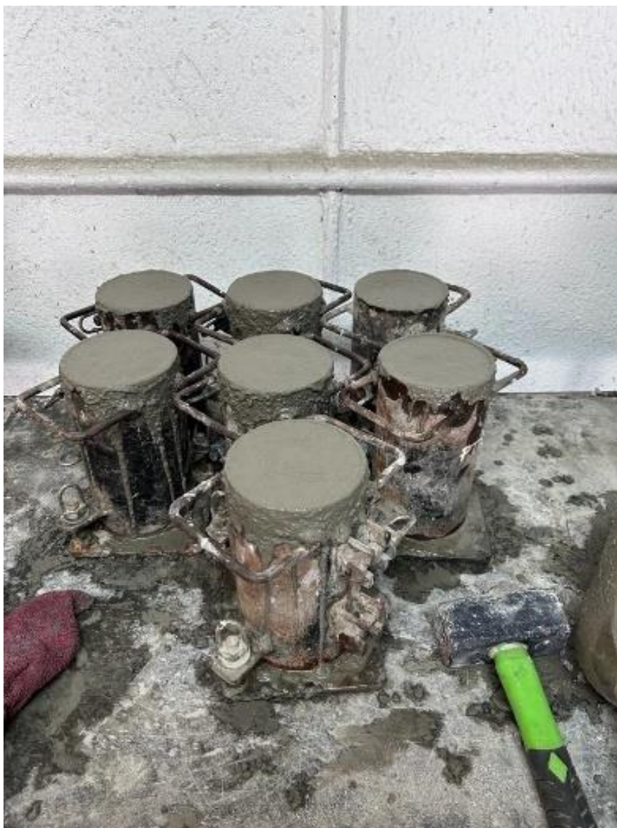
Anexo 19: Especímenes de hormigón debidamente compactados.
