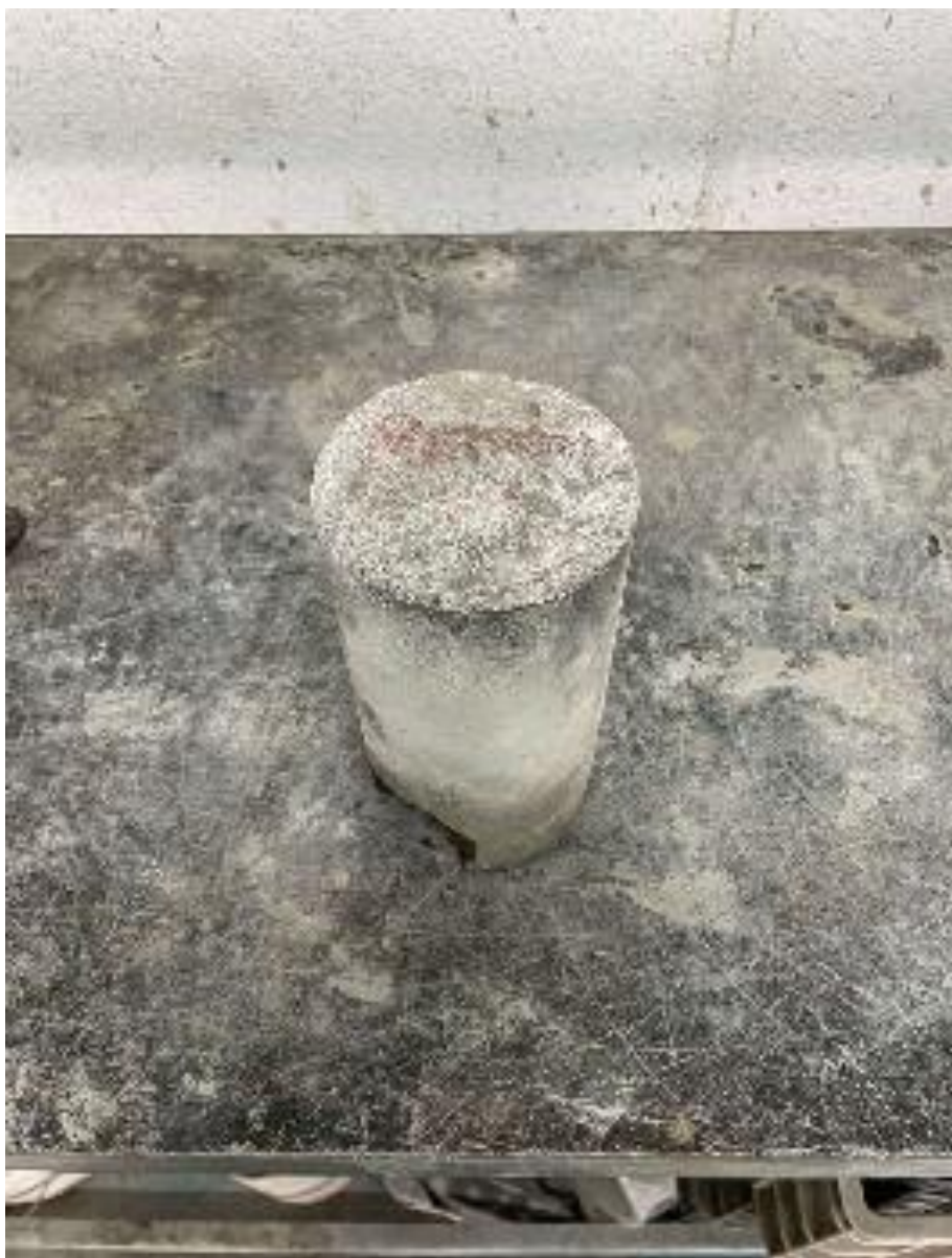
Anexo 25: Rotura de tipo T5, hormigón tradicional edad (3 días).
