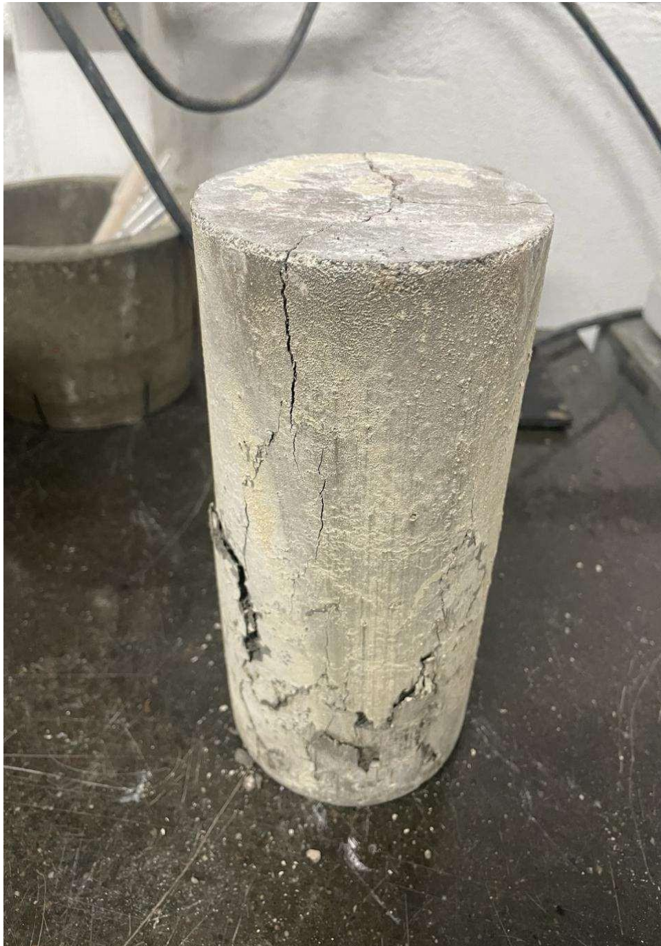
Anexo 41: Rotura tipo T3, hormigón adicionando 20% concreto triturada edad (14 días).
