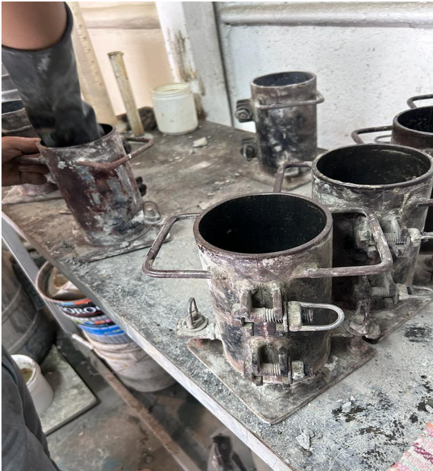
Anexo 16: Proceso de engrasado de probetas cilíndricas con aceite automotriz.
