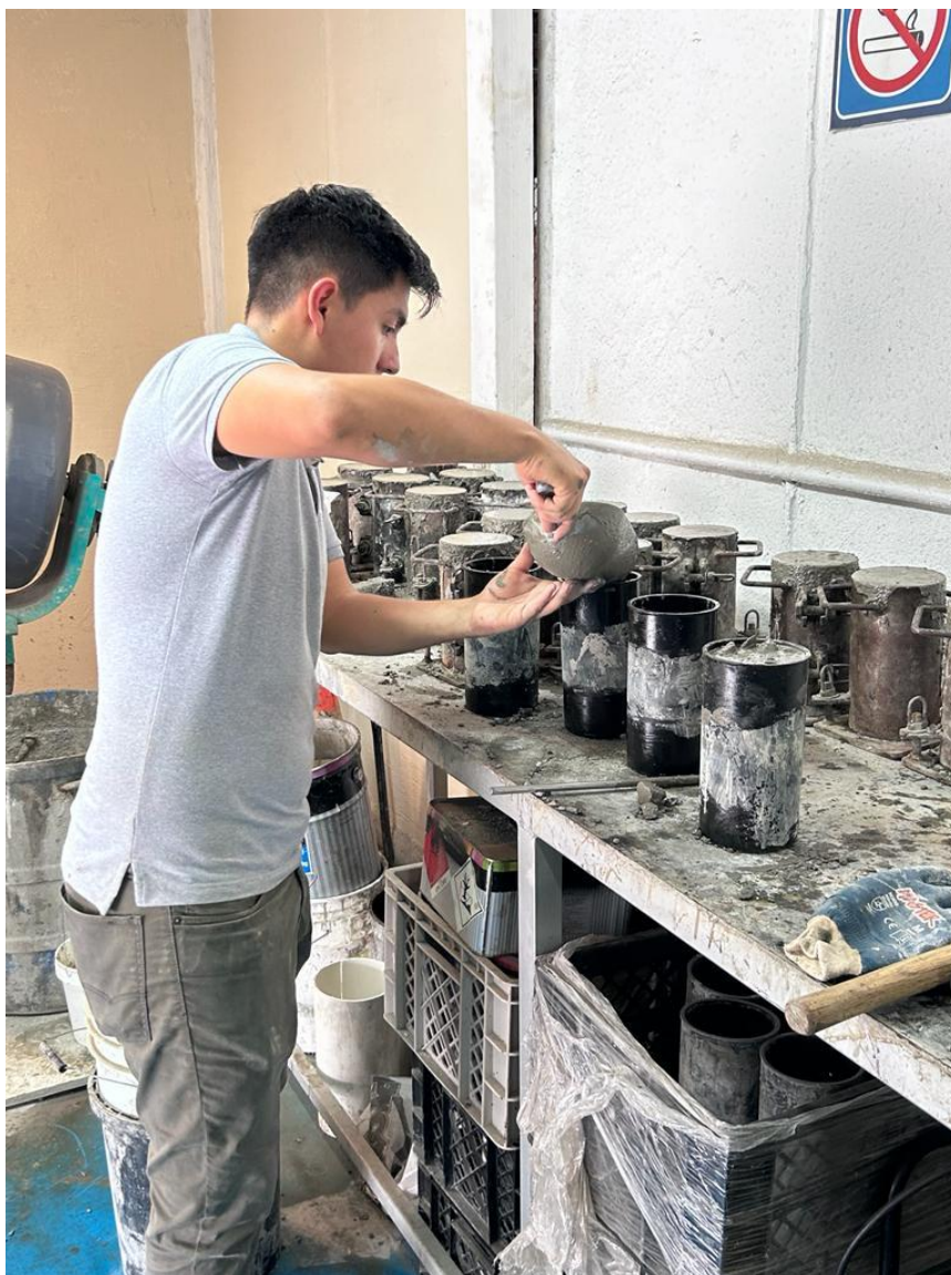
Anexo 17: Vertido de la mezcla de hormigón en probetas cilíndricas.
