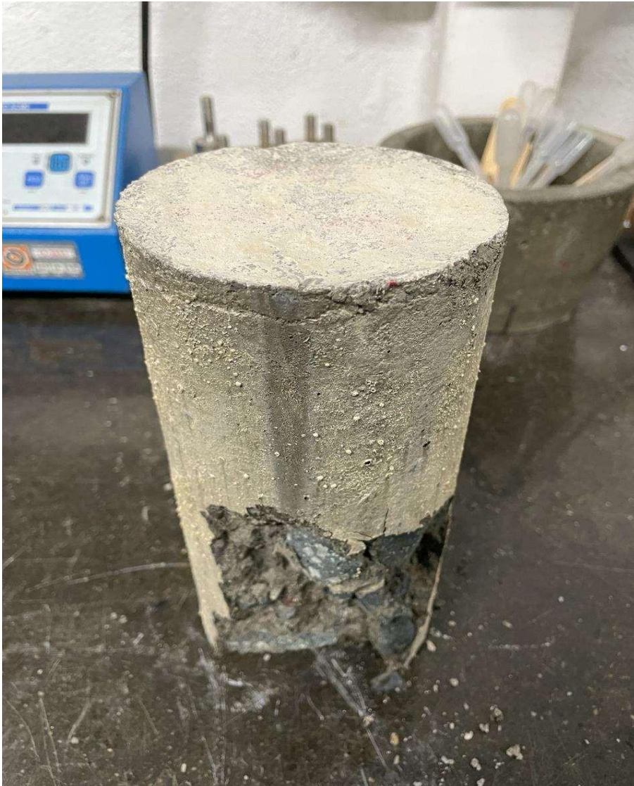
Anexo 33: Rotura tipo T5, hormigón adicionando 10% concreto triturada edad (7 días)
