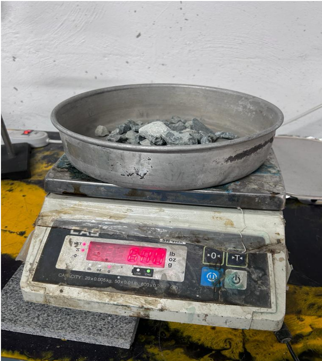
Anexo 6: Pesado del agregado grueso sin humedad (no contenía)
