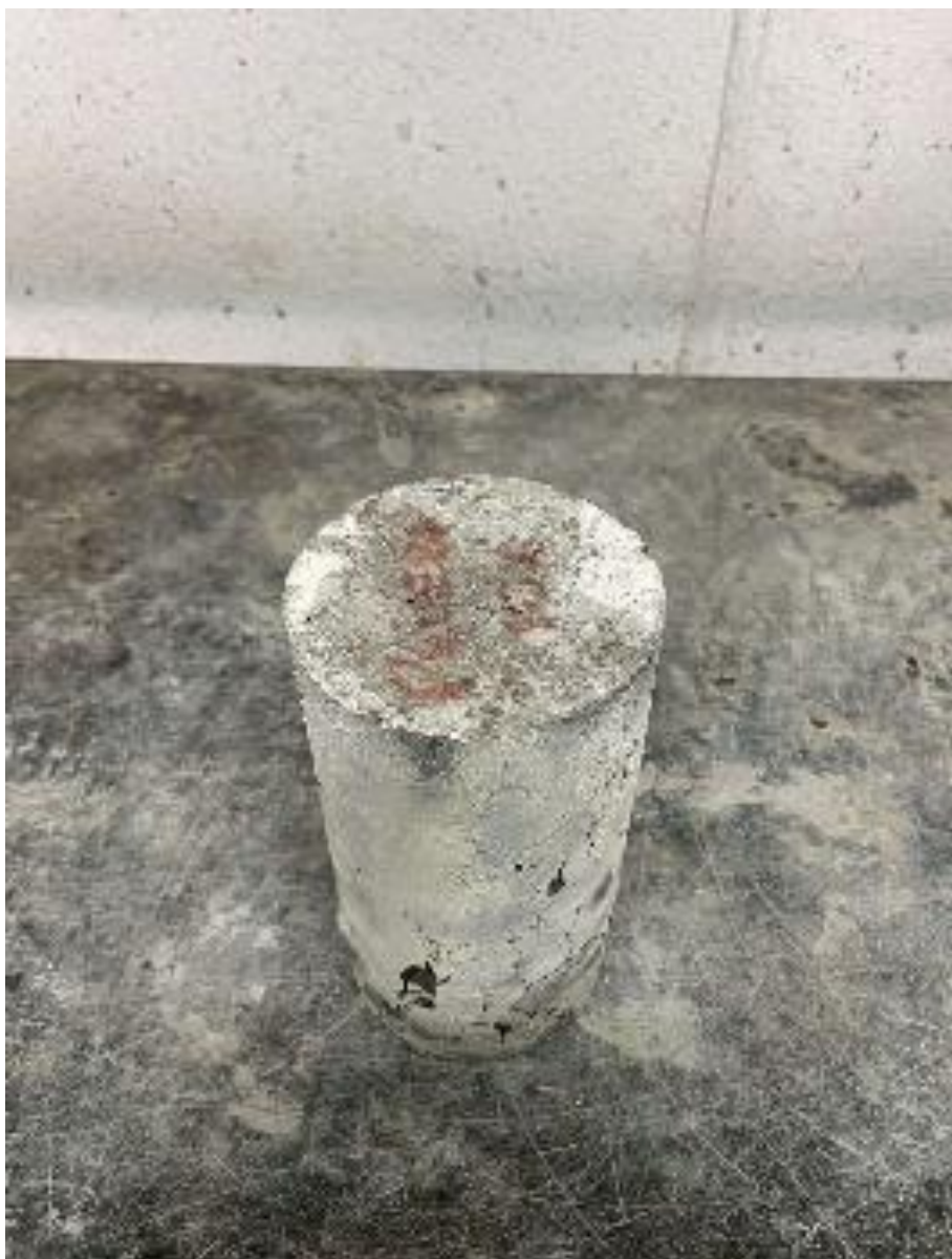
Anexo 27: Rotura tipo T2, hormigón adicionando 10% concreto triturada edad (3 días)
