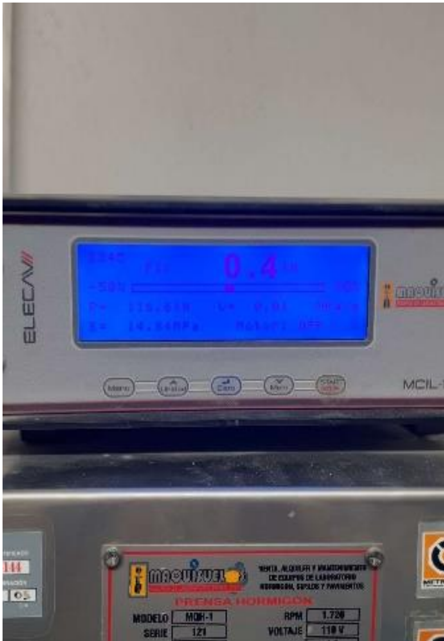
Anexo 24: Resultado de ensayo a la compresión, hormigón tradicional edad (3 días).
