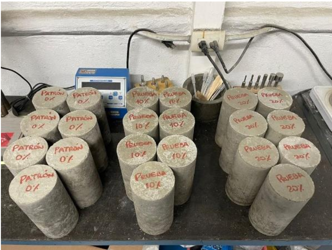
Anexo 20: Muestras de hormigón preparadas para ser curadas.
