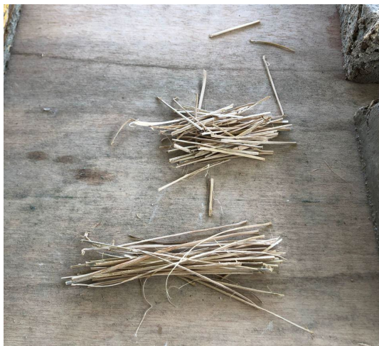
Figura 27: Fibras de bambú cortadas en 12 cm de largo
