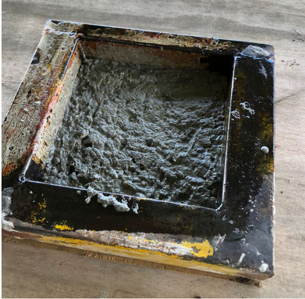
Figura 30: Colocación 1 capa de hormigón de 2 cm. Prototipo PTYH 01.
