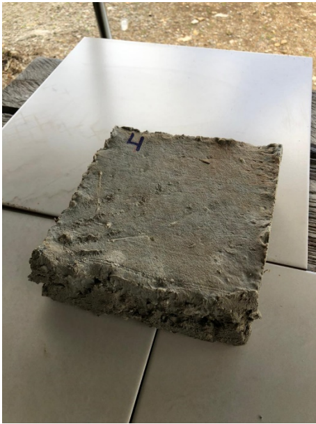
Figura 38: Concreto invertido con las 2 capas del prototipo PTYH 03.
