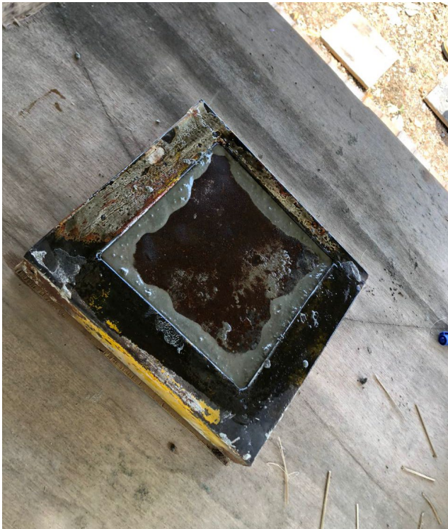
Figura 31: Encofrado del hormigón con la fibra de bambú. Prototipo PTYH 01.
