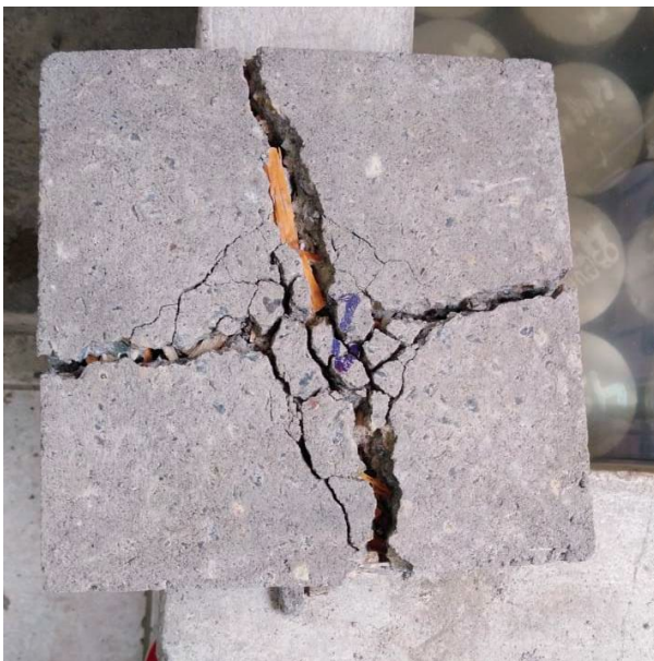
Figura 48: Resultado de la prueba de compresión del prototipo PTYH 01
