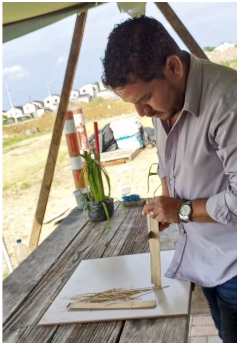
Figura 43: Corte de las fibras a 12cm prototipo PTYH 05
