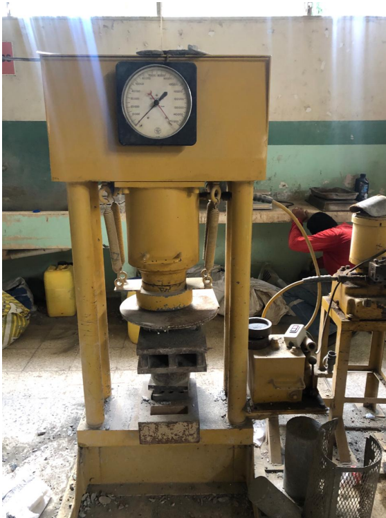
Figura 51: Prueba de compresión del prototipo PTYH 03
