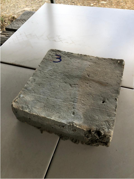
Figura 32: Resultado con 20% de fibra de bambú. Prototipo PTYH 01.
