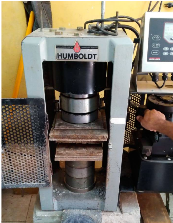
Figura 46: Equipo de prueba de compresión del prototipo PTYH 02
