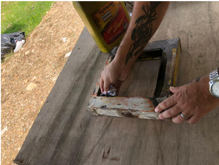
Figura 29: Colocación de aceite de motor en el molde. Prototipo PTYH 01.
