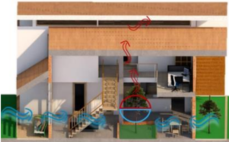
Ilustración 14: Diseño de ventilación para prototipo de vivienda
