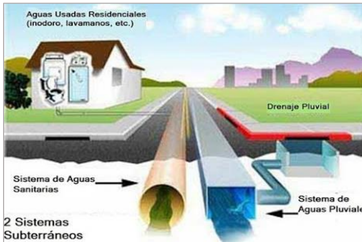
Figura 6 Sistema de alcantarillado separado
