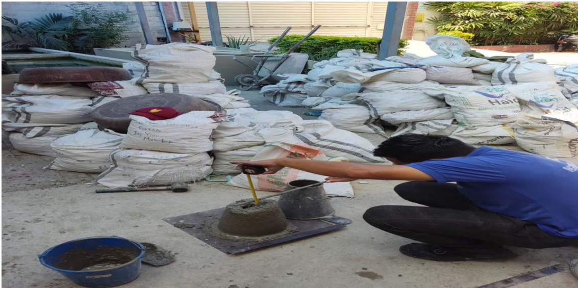
Figura 8 Revestimiento de los cilindros
