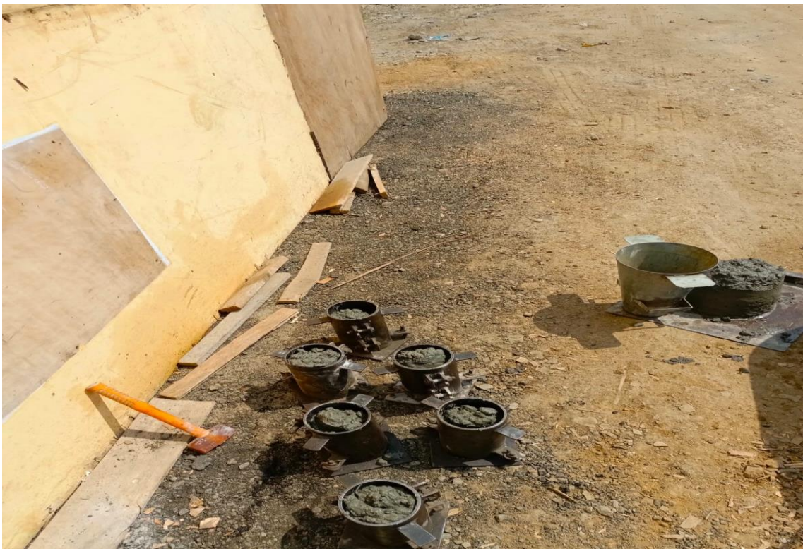
Figura 22 Fraguado de cilindros
