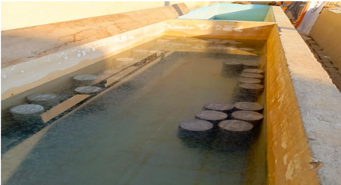
Figura 13 Cilindros clasificados por días
