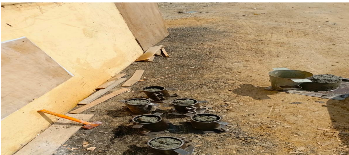
Figura 9 Fraguado de cilindros
