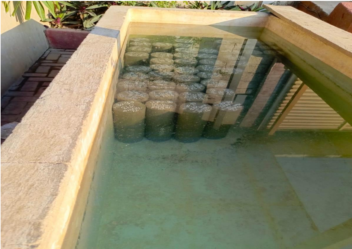
Figura 25 Secado de cilindros
