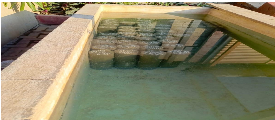
Figura 12 Secado de cilindros
