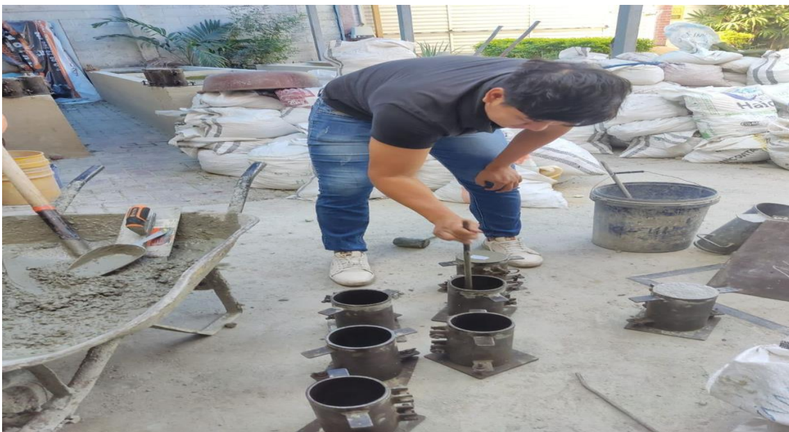
Figura 6 Llenado de los cilindros
