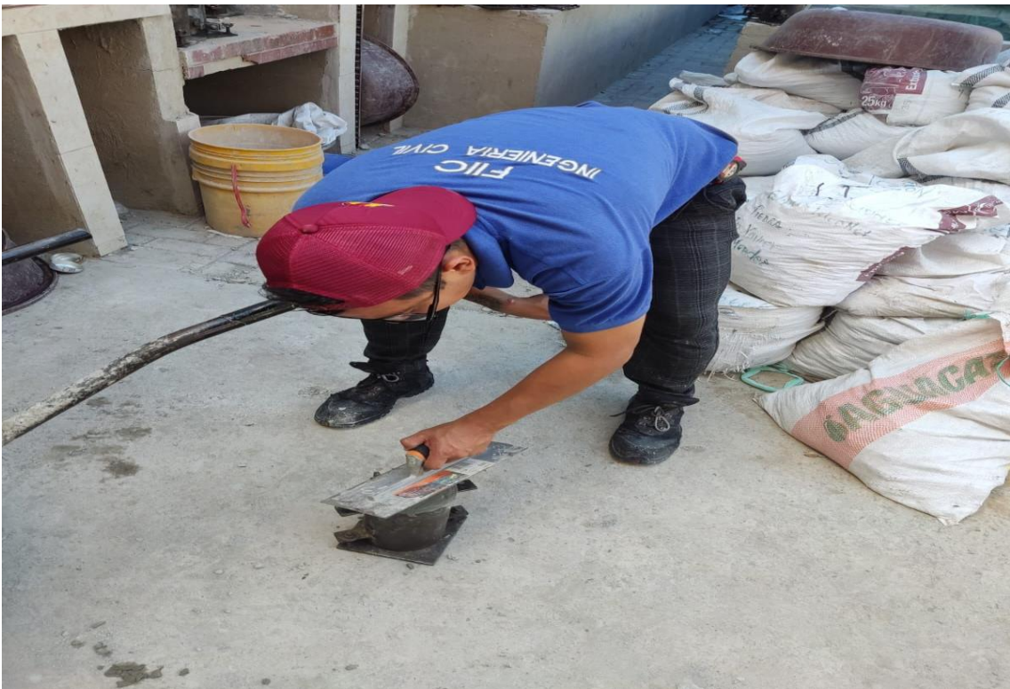
Figura 20 Cubrimiento de los cilindros
