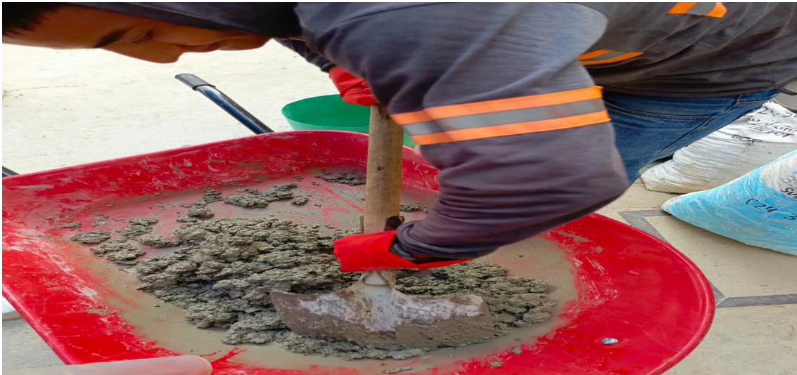
Figura 5 Aplicación de fibras de aluminio reciclado
