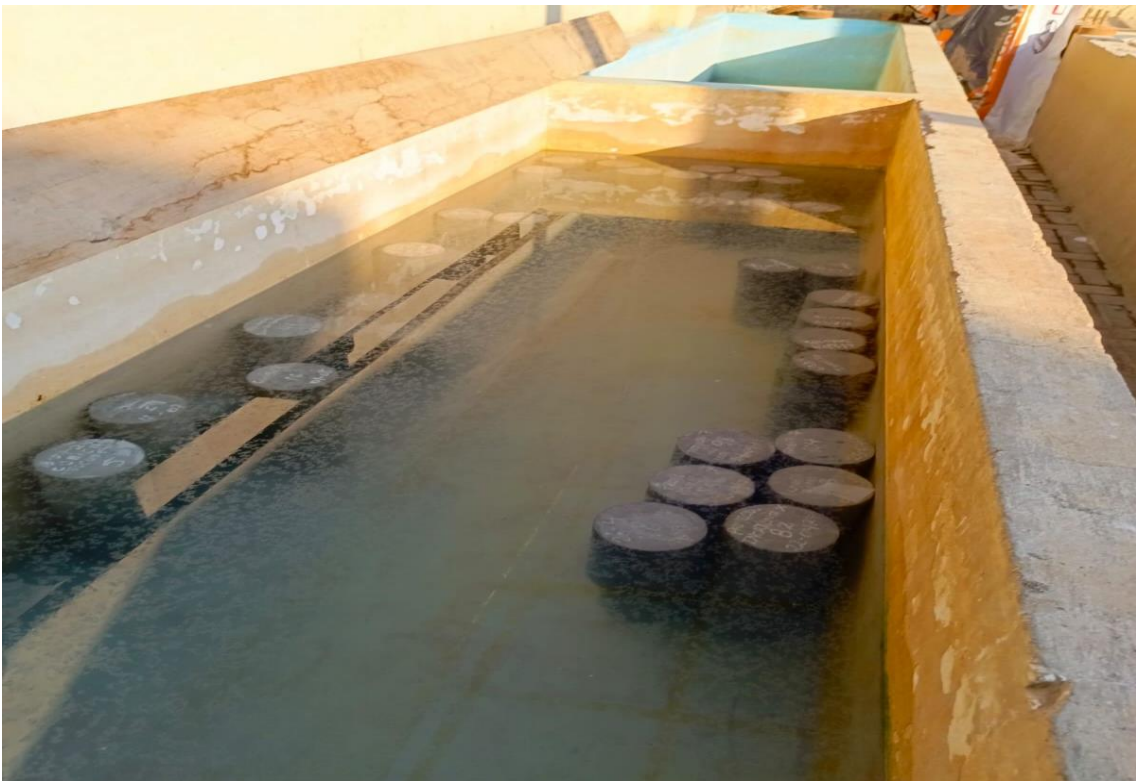
Figura 26 Cilindros clasificados por días
