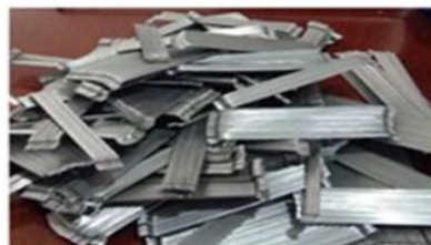
Fibras de acero con ganchos en los extremos
