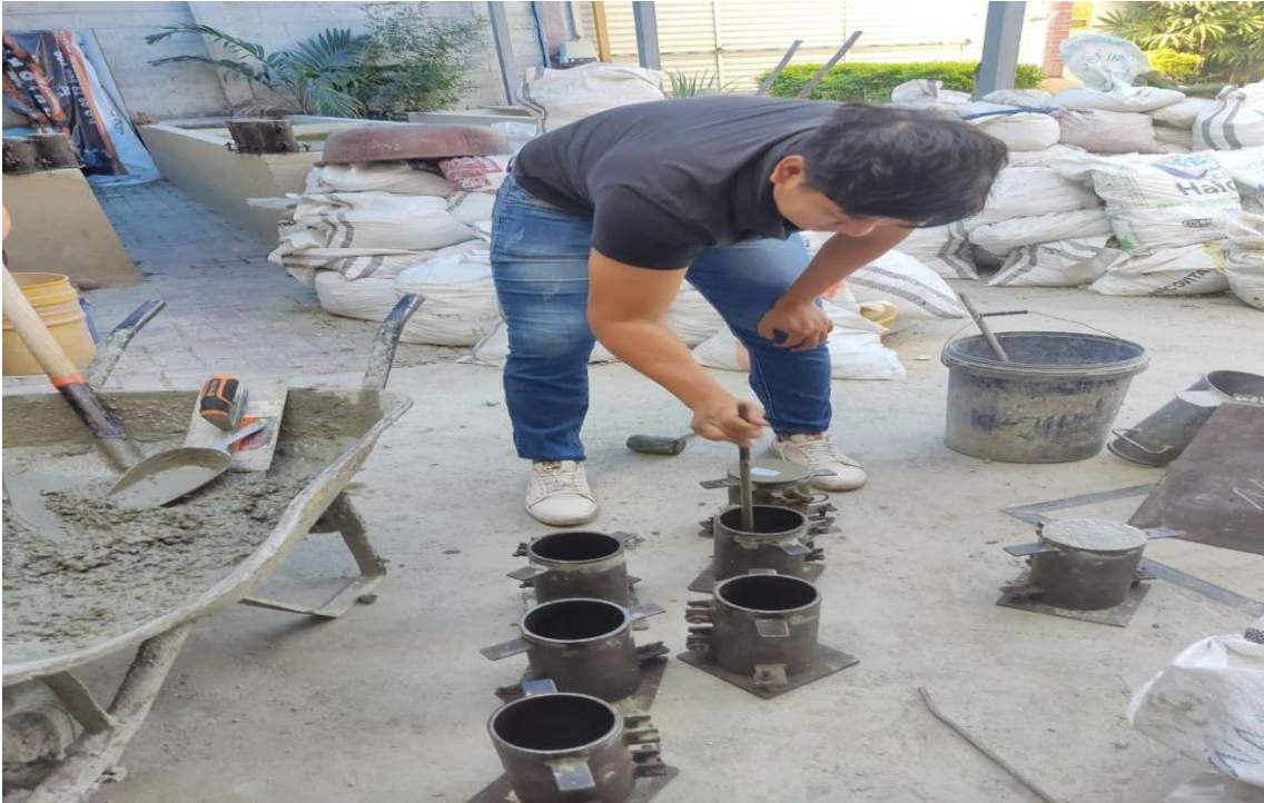
Figura 19 Llenado de los cilindros
