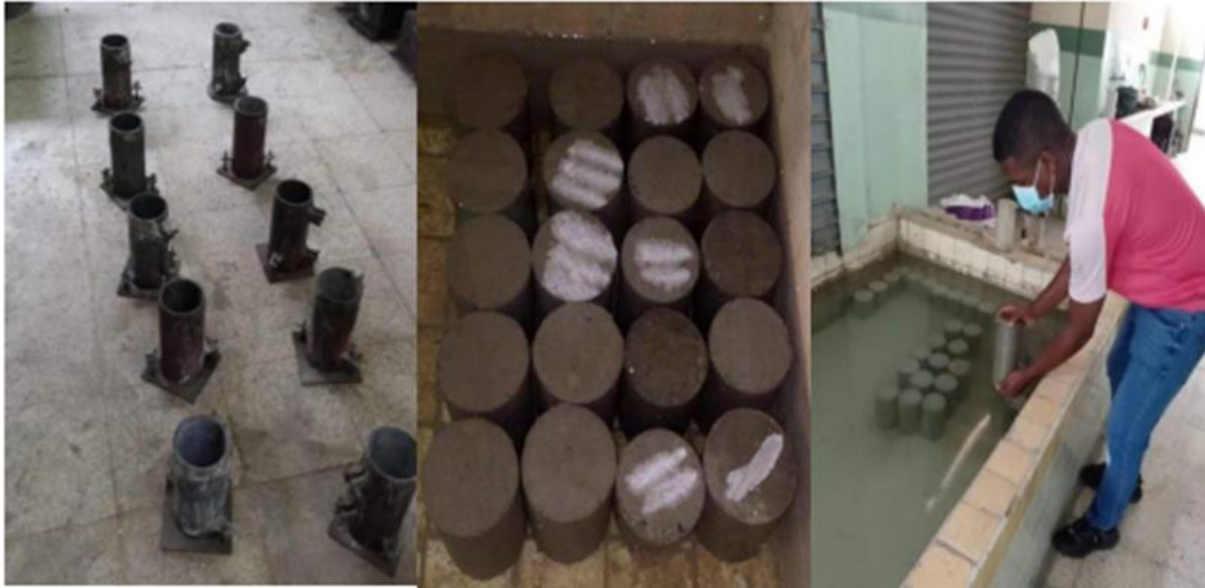
Figura 15: Procesos y curado de hormigón de cilindro
