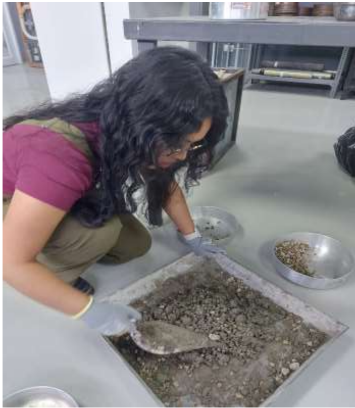
Anexo 1: Elaboración del bloque del ensayo de conductividad térmica
