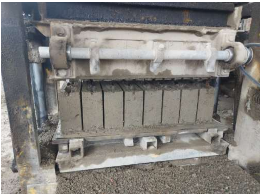
Figura 14: Acabado final de los bloques con fibra de coco y BCA
