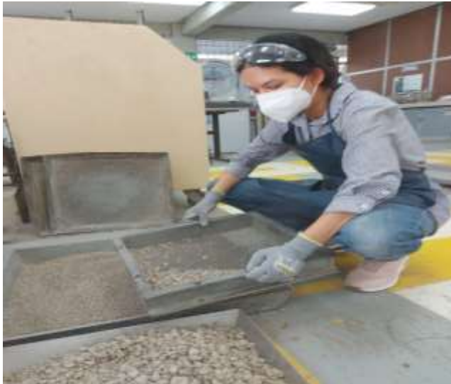
Figura 6: Tamizado del Chasqui por el tamiz No.4
