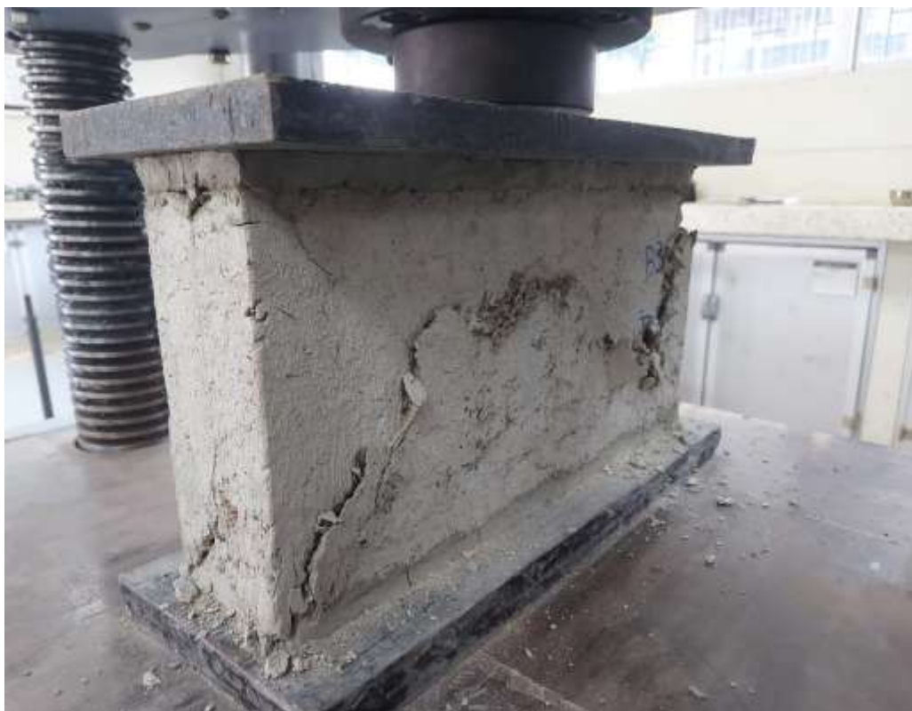
Anexo 9: Falla del bloque 3 de la dosificación 3
