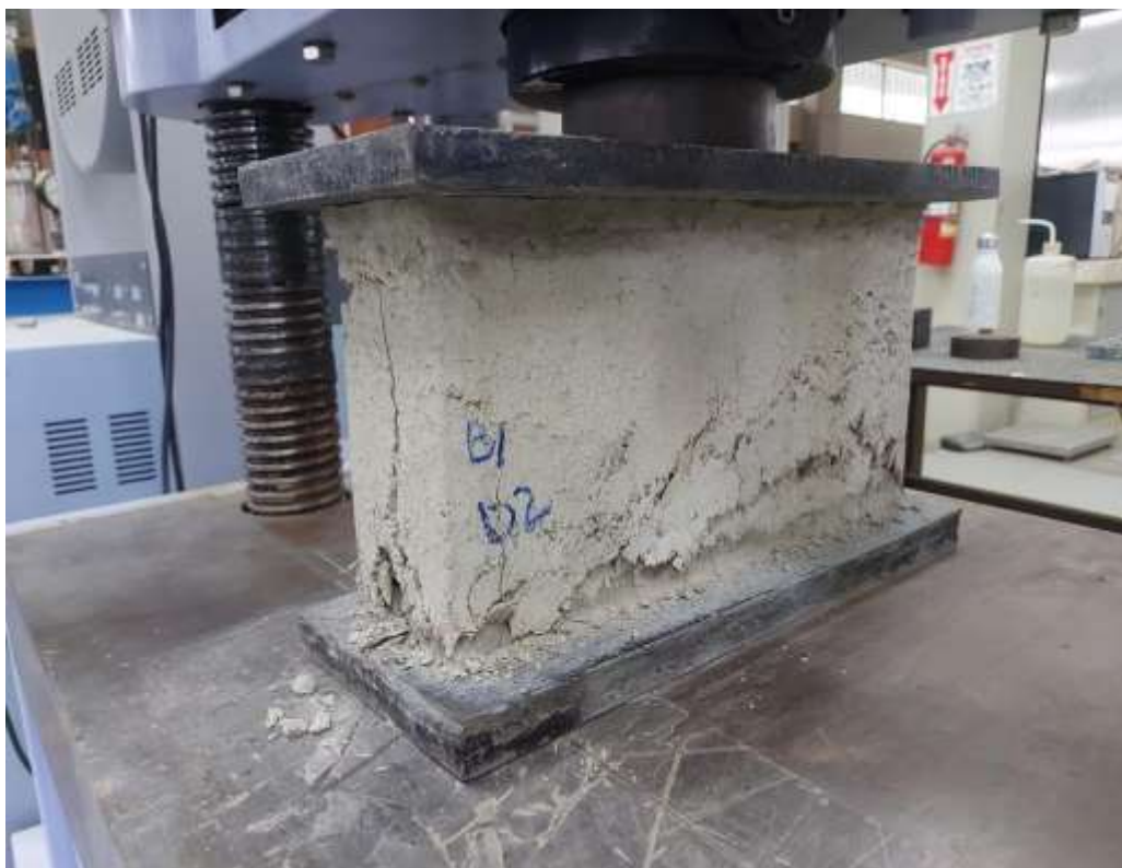
Anexo 10: Falla del bloque 1 de la dosificación 2
