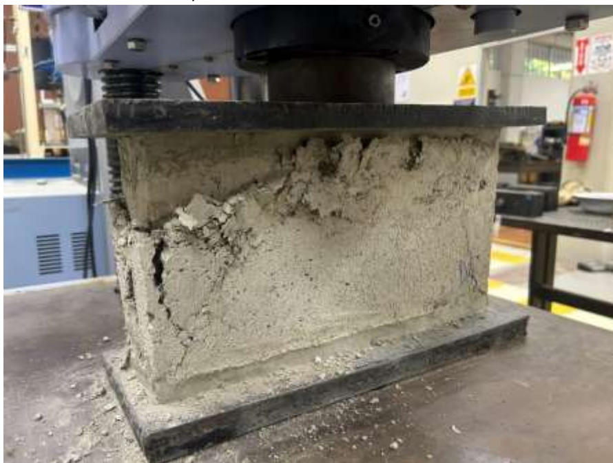
Anexo 8: Falla del bloque 1 de la dosificación 3
