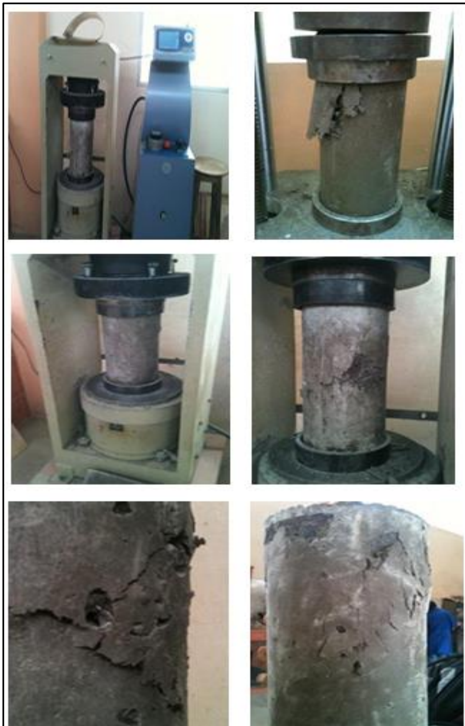
Figura 16. Compresión de probetas
