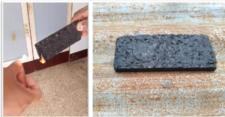
Gráfico 55 Prueba de resistencia al fuego
