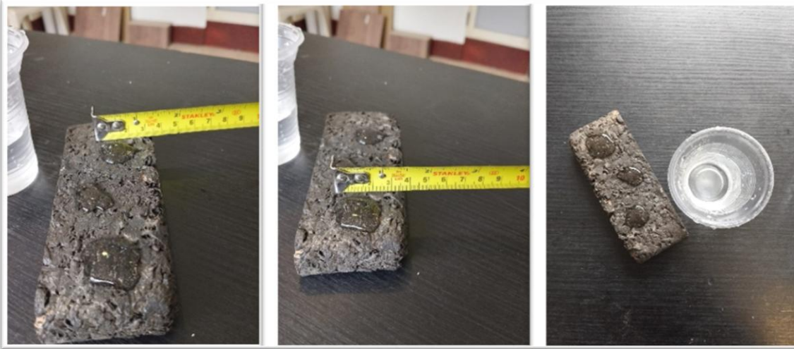
Gráfico 39 Absorción de agua sobre la superficie
