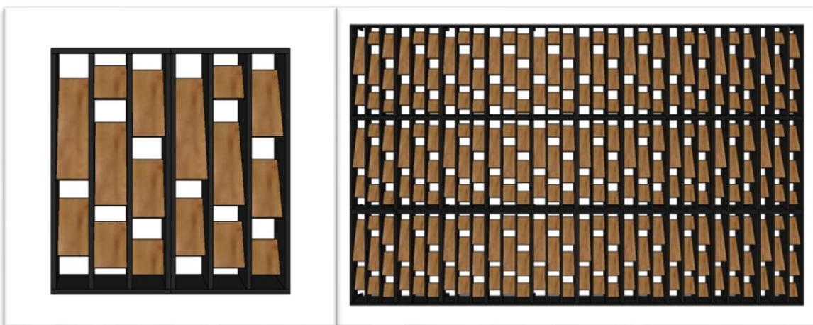
Gráfico 50 Diseño modular, pueden unirse y crear una pantalla para recubrimientos de fachadas
