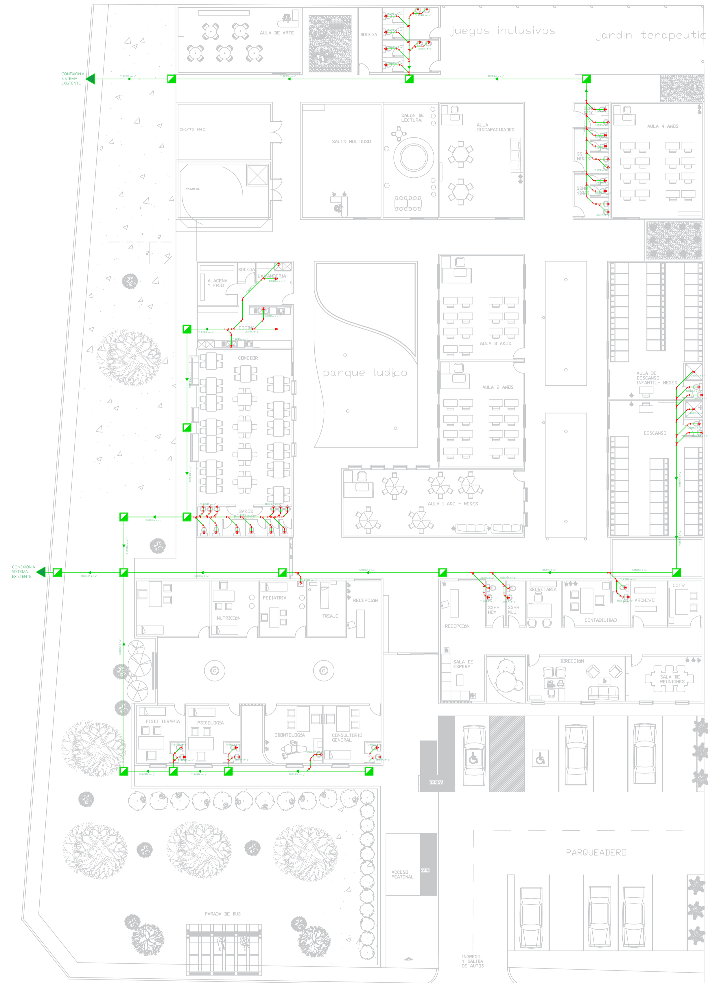
PLANO HIDROSANITARIO DE AGUAS SERVIDAS
