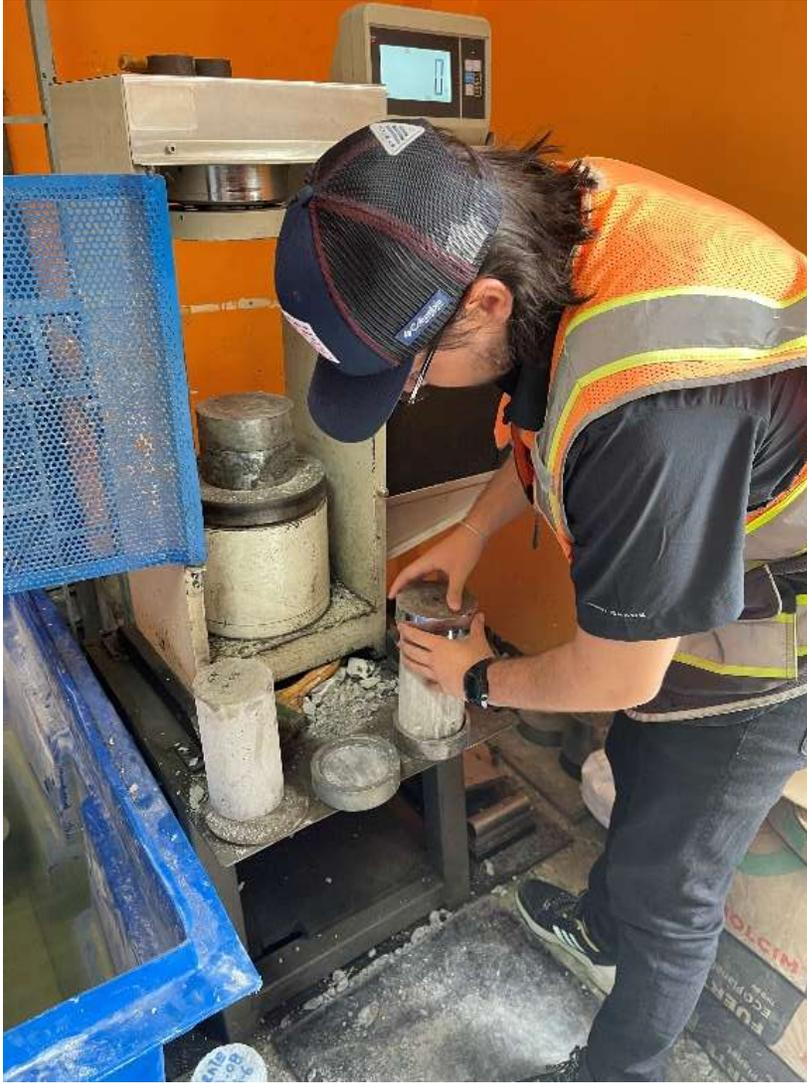
**Anexo 2 Ruptura del cilindro de hormigón**
