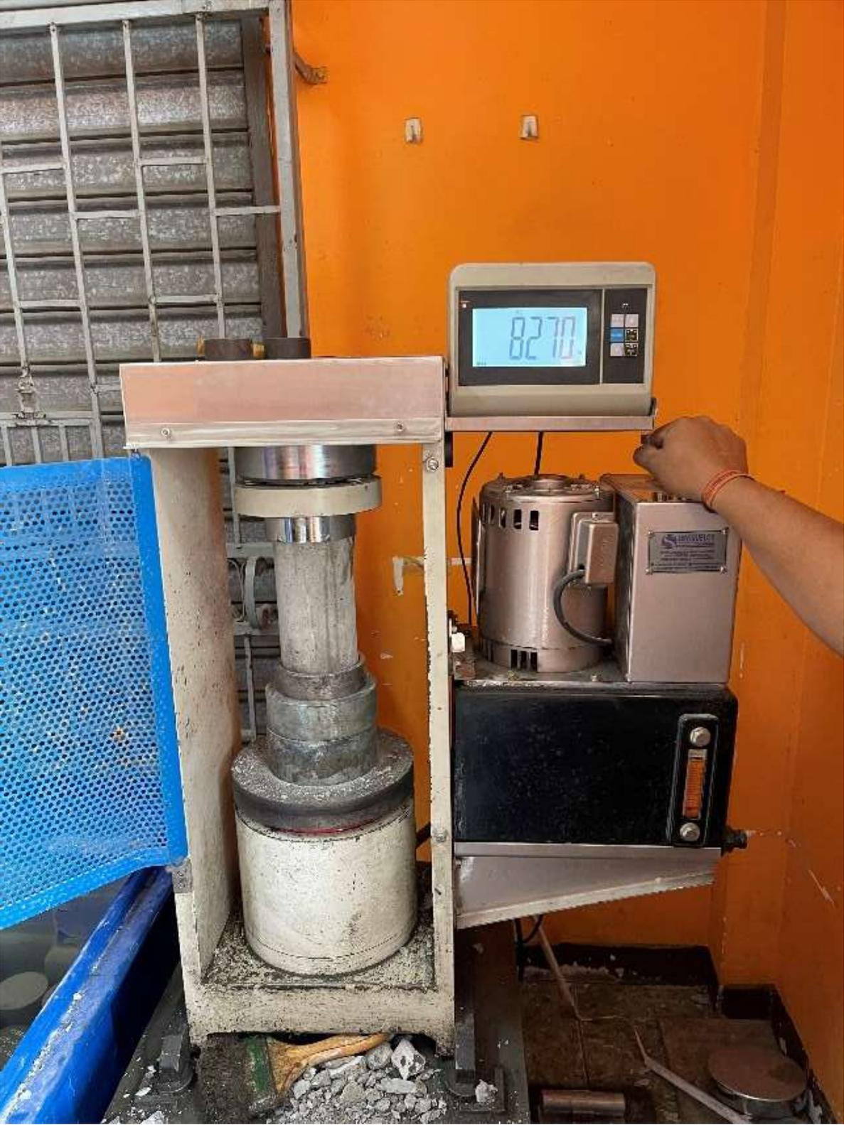
**Anexo 3** Análisis manual de los cilindros de hormigón sometidos a compresión
