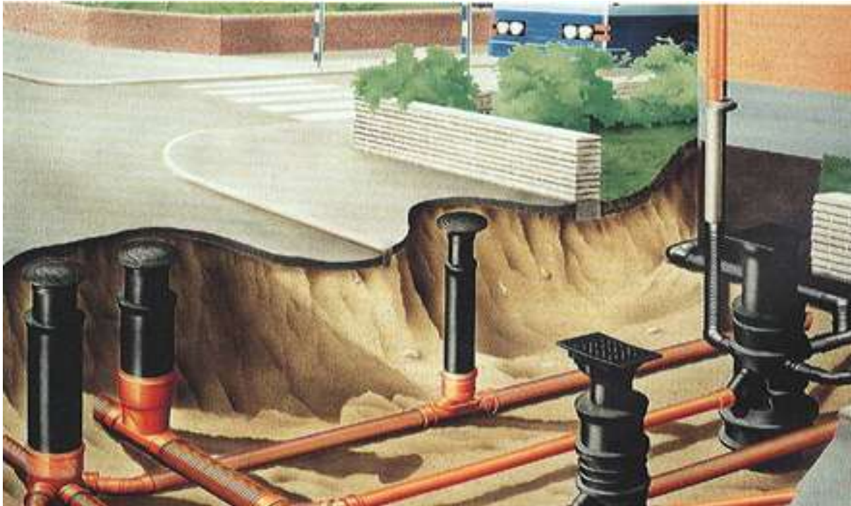
Figura 14. Redes de alcantarillado
