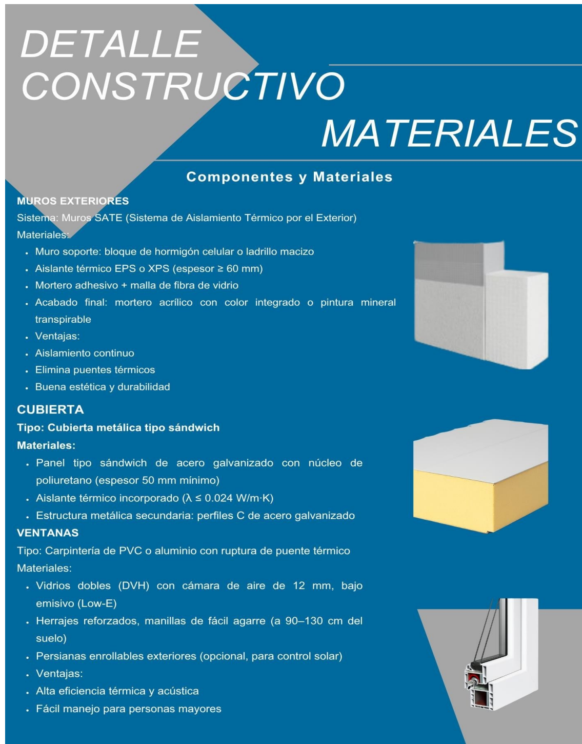
Ilustración 40 Detalles constructivos Materiales
