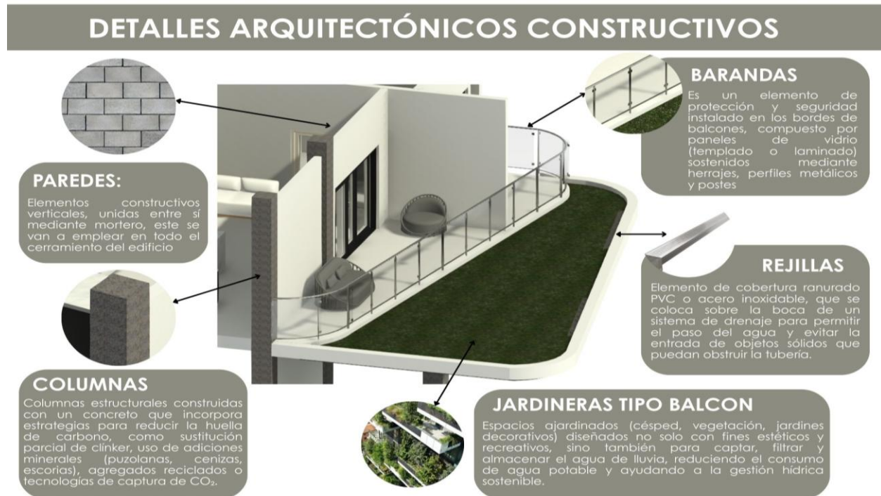
Figura 42. Detalles arquitectónicos constructivos
