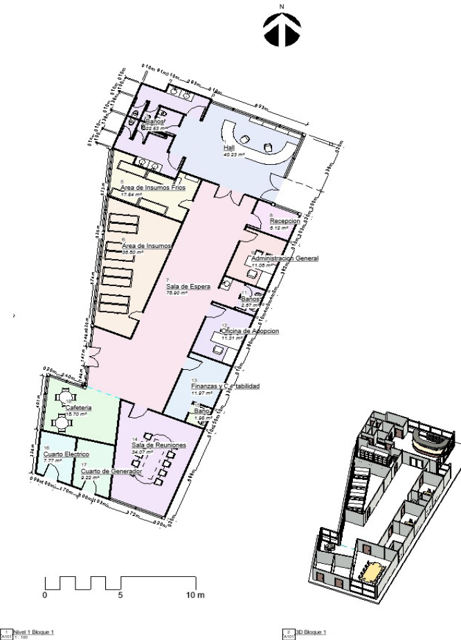
Figura 58 Plano Arquitectónico Área de Administración
